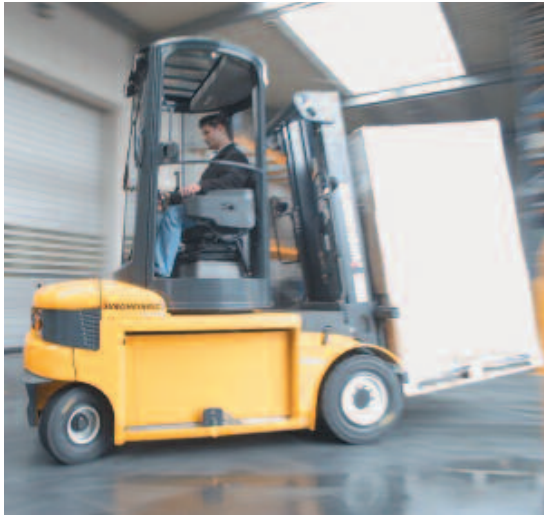
Bild 6-17: Gabelstapler mit drehbarer Fahrerkabine – System „Jungheinrich“
