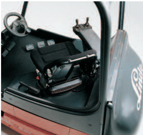
Bild 6-18: Drehbarer Fahrersitz – System „Linde“
