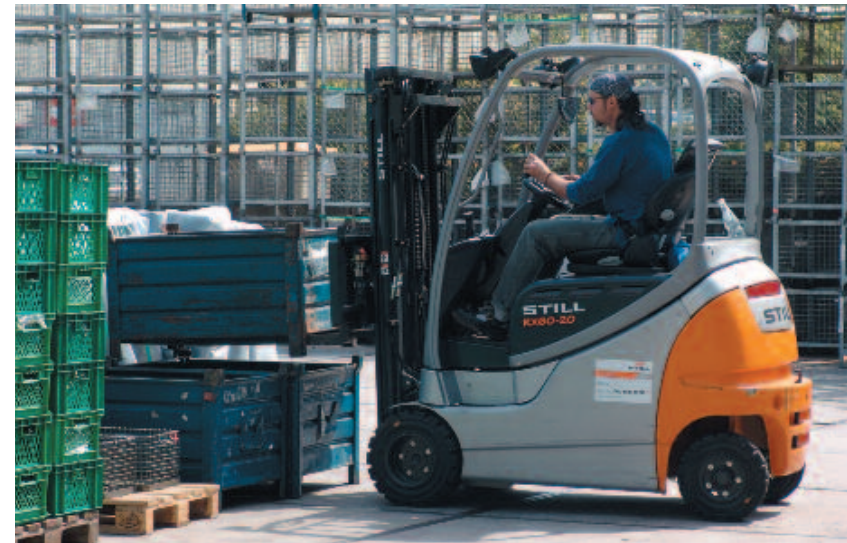
Bild 2-4: Gabelstapler mit Fahrerschutzdach
