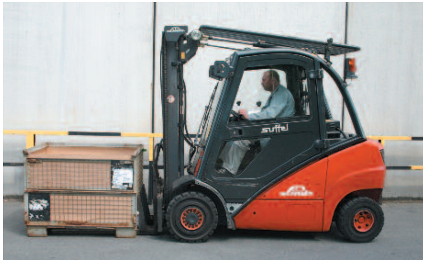
Bild 6-9: Damit der Lastschwerpunkt in der Nähe der Vorderachsen liegt, Last immer so aufnehmen, dass sie am Gabelrücken anliegt
