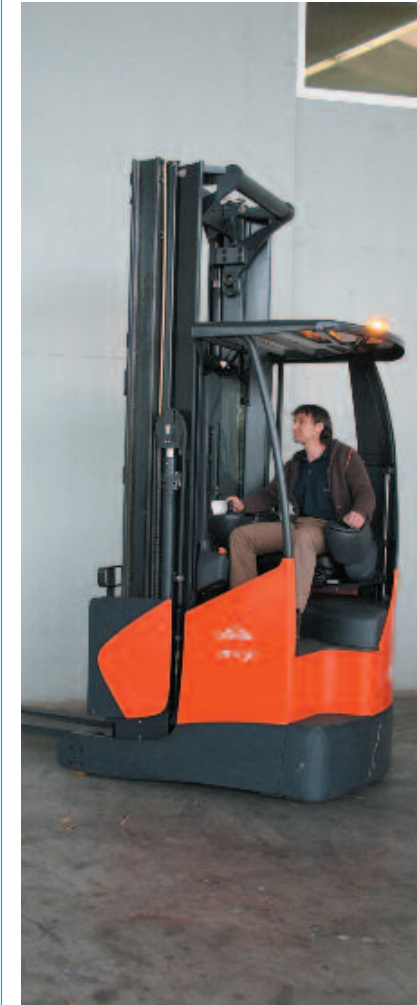
Bild 6-16: Für regelmäßiges Rückwärtsfahren geeigneter Quersitzstapler
