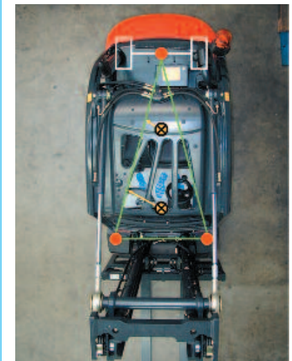
Bild 6-25: Kippkanten-Dreieck mit Hebelarmen – senkrechter Abstand Schwerpunktlage bis Kippkante – des leeren und beladenen Gabelstaplers
