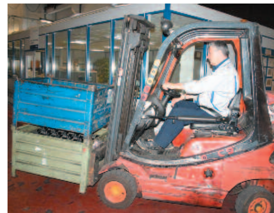
Bild 6-14: Nach hinten geneigter Hubmast
