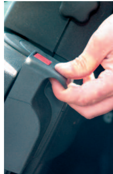
Bild 7-2: Durch Anziehen der Feststellbremse wird der Gabelstapler gegen unbeabsichtigte Bewegungen gesichert
