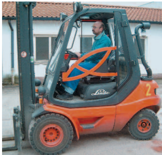
Bild 2-7: Bügeltüren als Rückhalteinrichtung
