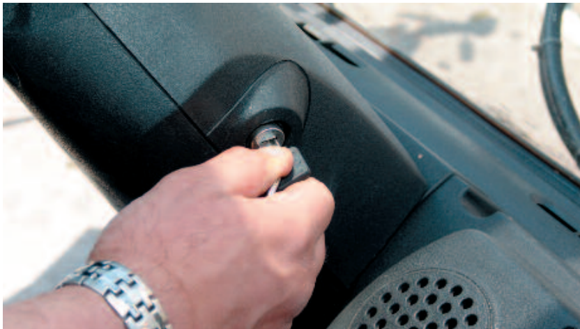
Bild 7-1: Gabelstapler erst verlassen, wenn Antrieb stillgesetzt und Schlüssel abgezogen ist
