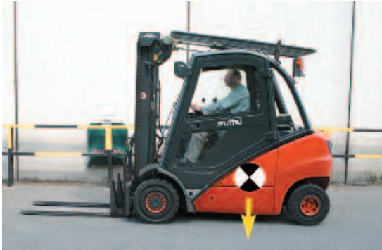
Bild 6-19: Der Schwerpunkt des Gabelstaplers und...
