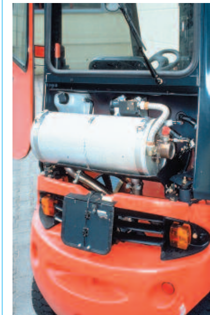
Bild 3-1: Gabelstapler mit Rußfilter und integrierter Regenerationsvorrichtung
