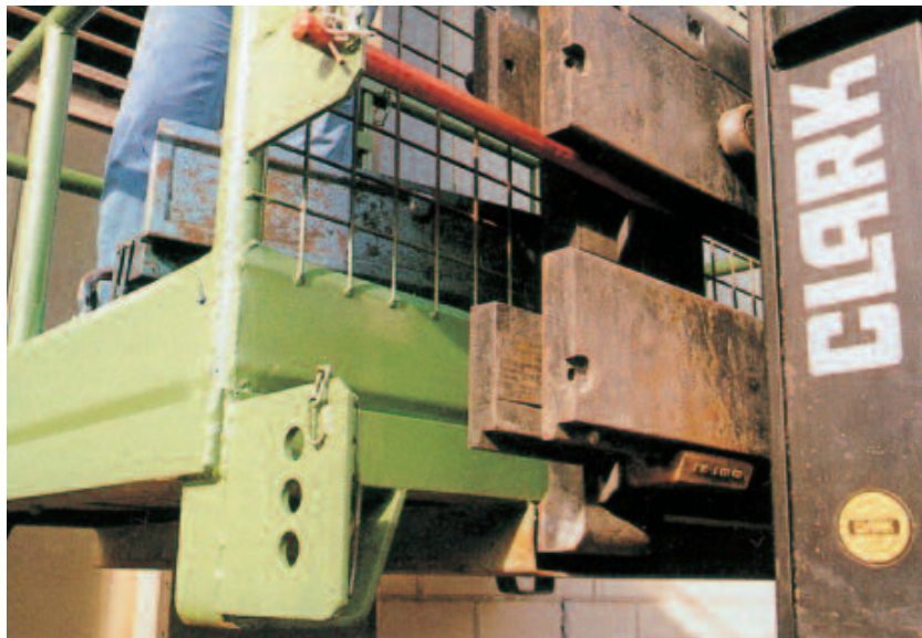
Bild 8-3: Formschlüssige Sicherung der Arbeitsbühne gegen Abkippen und Abrutschen
