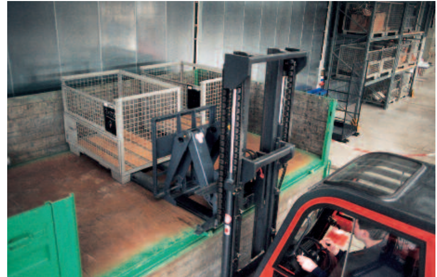
Bild 8-6: Gabelstapler mit Schubgabel
