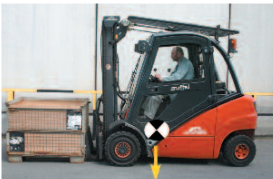
Bild 6-21: ... ergeben den Gesamtschwerpunkt bei abgesenkter Last
