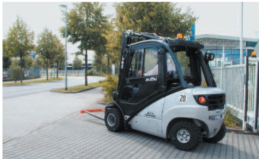
Bild 8-7: Gabelstapler mit Sonderausstattung für den Einsatz auf öffentlichen Straßen
