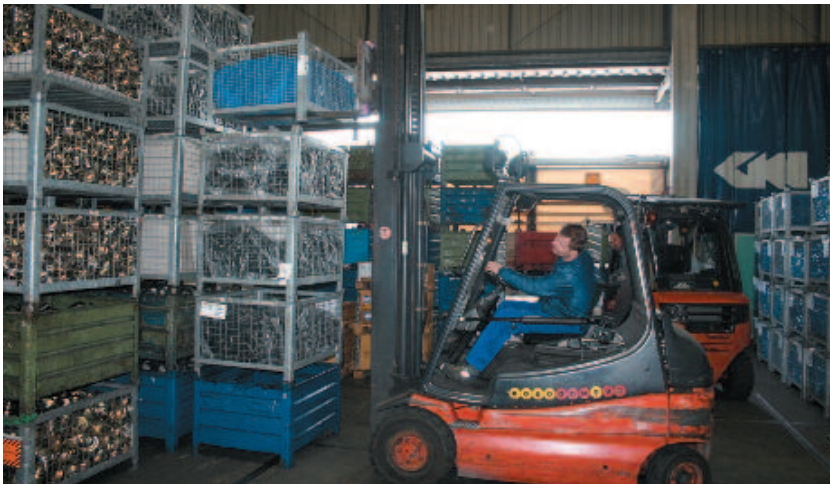
Bild 6-15: Nur zum Auf- und Absetzen mit hoch gestellter Last verfahren
