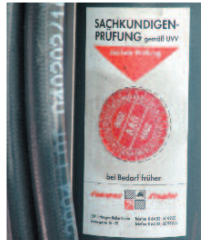
Bild 5-2: Die Prüfplakette erleichtert es dem Fahrer, die Prüf Fristen zu überwachen
