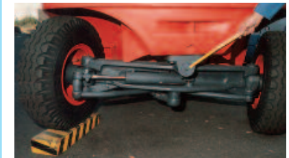
Bild 6-25: Kippkanten-Dreieck mit Hebelarmen – senkrechter Abstand Schwerpunktlage bis Kippkante – des leeren und beladenen Gabelstaplers
