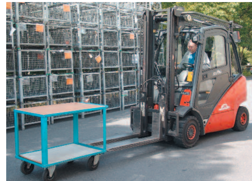
Bild 6-1: Das Verschieben von Gegenständen mit den Gabelzinken ist unzulässig
