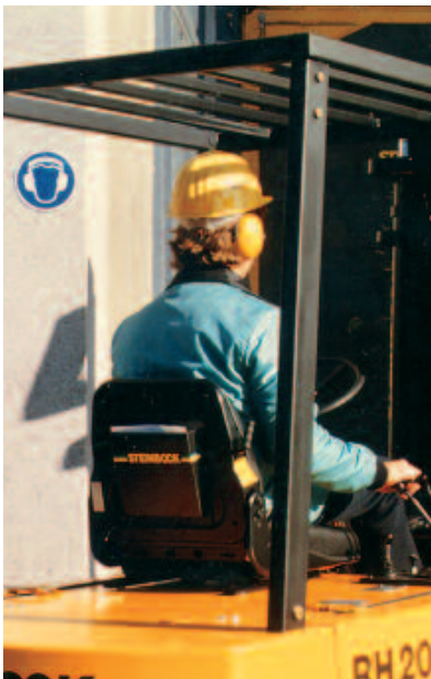
Bild 3-2: Ergonomisch ausgebildeter Fahrersitz. Fahrer trägt im Lärmbereich Gehörschutzkapseln
