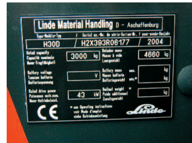
Bild 2-1: Fabrikschild mit CE-Zeichen für ein Flurförder- zeug
