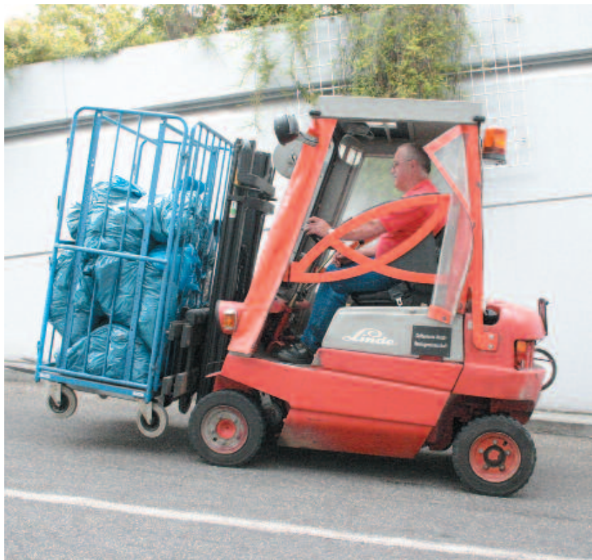
Bild 6-23: Last immer bergseitig führen
