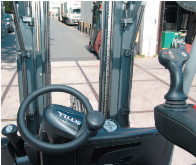
Bild 2-5: Optimal angeordnete Stellteile und bessere Sicht durch ein Freisichthubgerüst gewährleisten ein ermüdungsfreies Arbeiten
