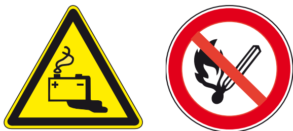
Abbildung 4: Erforderliche Warn- und Verbotssymbole für eine Batterieladeanlage
