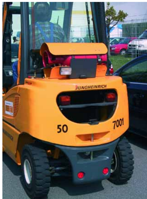
Abb. 3: Schlussleuchten, Bremsleuchten, Rückstrahler und Fahrtrichtungsanzeiger
