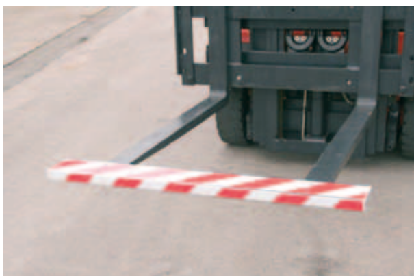
Abb. 2: Schutzvorrichtung zum Abdecken der Gabelspitzen
