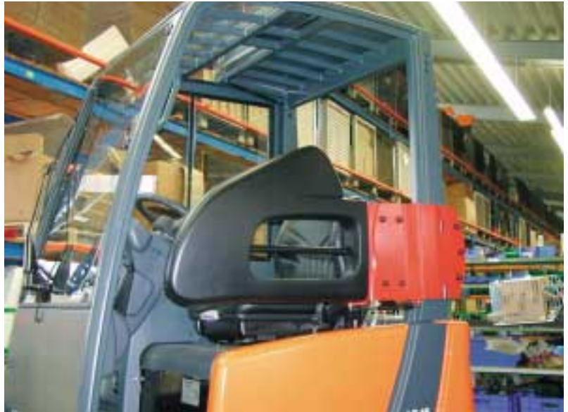
Abb. 4: BÜgeltür mit im Scharnier integriertem Türschloss
