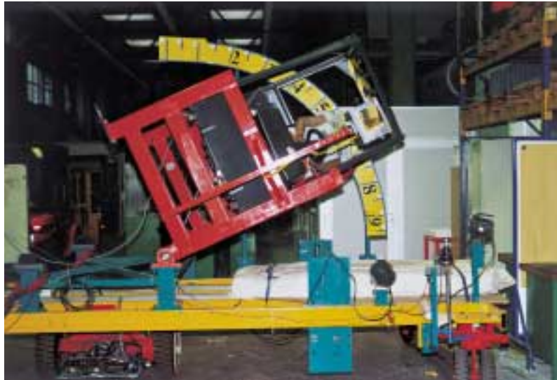
Abb. 5: Funktionsprüfung einer Fahrerrückhalteeinrichtung an der Universität Duisburg
