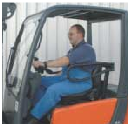
Abb. 5: Diese Türbügel schließen sich kraftbetrieben, sobald die Parkbremse gelöst wird. Der sicherheitstechnische Vorteil liegt darin, dass sich beim Aussteigen die Türbügel nur öffnen lassen, wenn zuvor die Parkbremse betätigt wurde.
