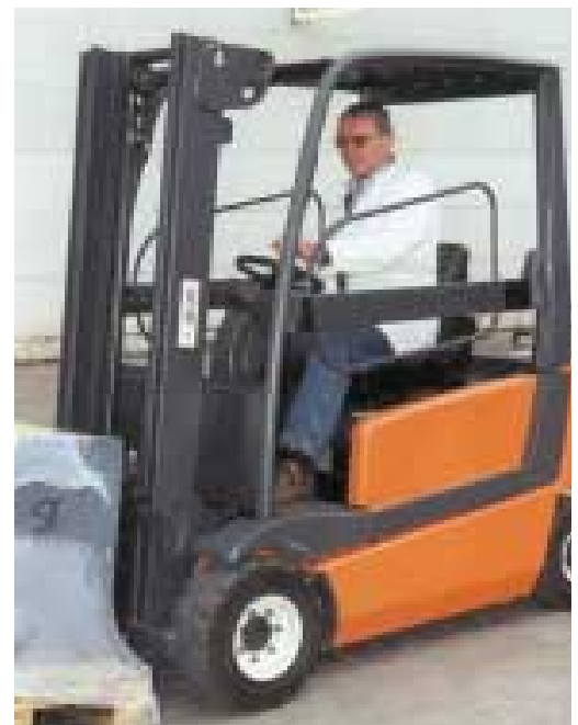
Abb. 2: Einfache Bügeltür, die beidseitig am Fahrerschutzdach befestigt ist.
