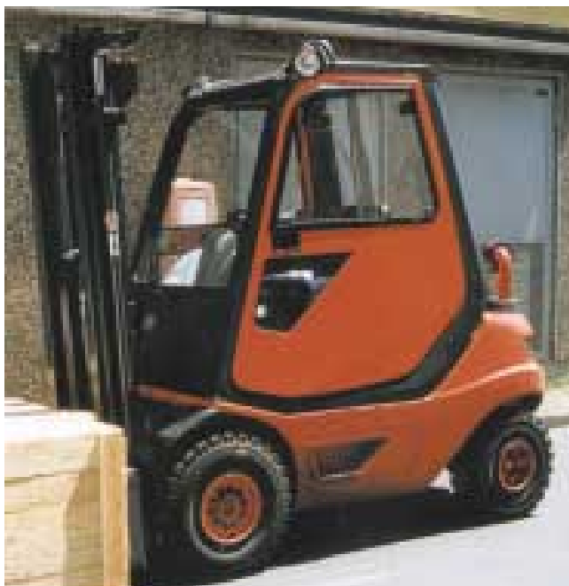
Abb. 1: Dienen Fahrerinnen als Fahrerrückhalteeinrichtungen, so muss sichergestellt sein, dass auch im Sommer die Kabinentür geschlossen gehalten wird.
