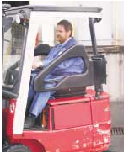
Abb. 3: Am Fahrerplatz anzubringendes Bügelsystem, das ähnlich einer Tür beim Besteigen bzw. Verlassen des Gabelstaplers zu öffnen bzw. zu schließen ist. Da die Türen maximal 90° geöffnet werden können, werden sie vom Fahrer vor Antritt der Fahrt zwangsläufig geschlossen.
