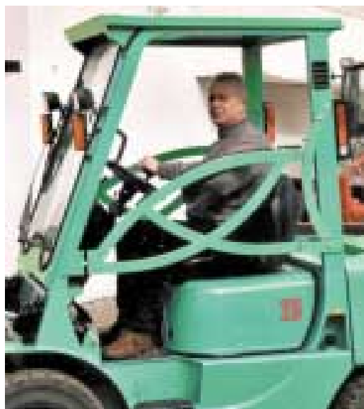
Abb. 4: Bügeltür, die unter besonderen ergonomischen Gesichtspunkten entwickelt wurde.
