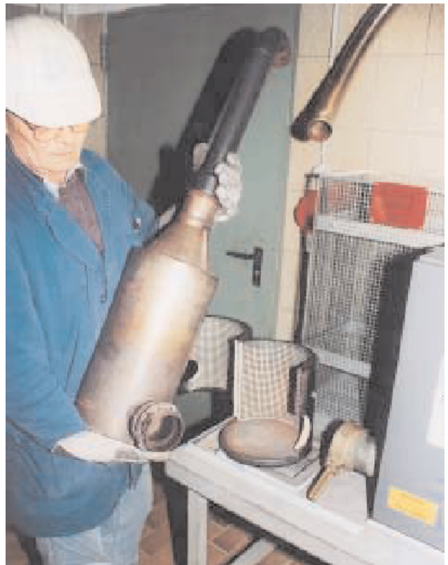
Abb. 3: Dieser Partikelfilter ist mit einer Schnellkuppung ausgerüstet. Er kann mit wenigen Handgriffen vom Gabelstapler abgenommen und an eine Filterreinigungsanlage angeschlossen werden.
