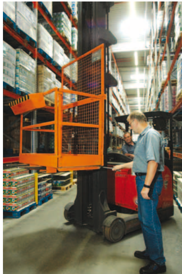
Die Arbeitsbühne ist mit einer allseitigen Umwahrung versehen. Sie ist so befestigt, dass sie sich weder verschieben noch abrutschen oder kippen kann. Zum Hubmast hin schützt ein hohes Gitter aus Maschendraht.
