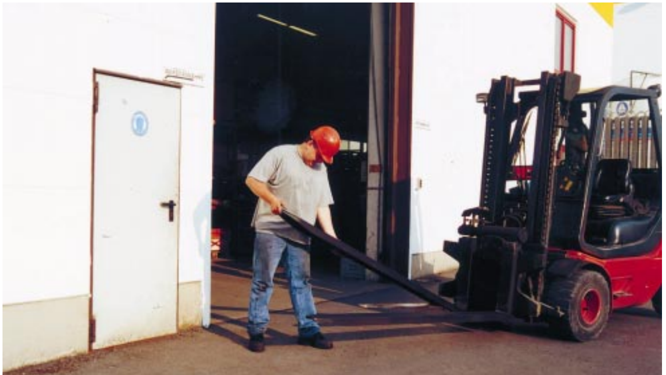
Abb. 2: Gabelschuhe bestehen aus Profilen, welche über die Gabelzinken geschoben und gesichert werden.
