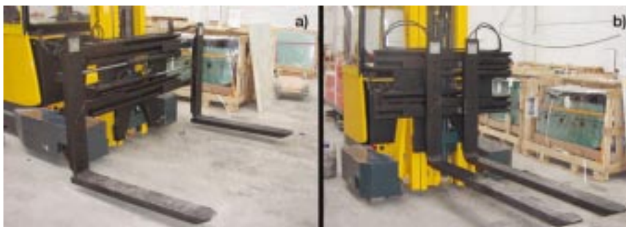
Abb. 5: Hydraulisch verstellbare Teleskopgabel kombiniert mit Zinkenverstellgerät: a) mit eingefahrener Gabel, Zinken weit b) mit ausgefahrener Gabel, Zinken eng
