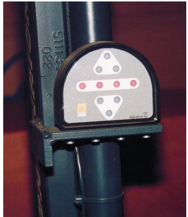
Abb. 6: Messung der Einfahrtiefe mit Hilfe von Sensoren: Display im Blickfeld des Fahrers signalisiert die richtige Einfahrtiefe
