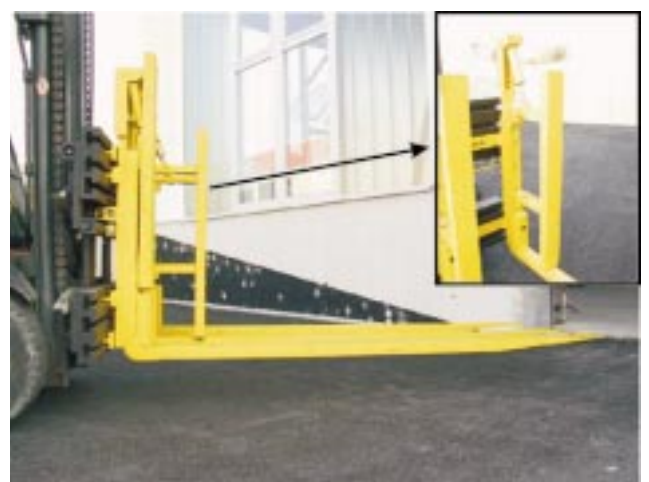
Abb. 4: Klappanschlag mit Anlagefläche für die Last; hier wurde zu Demonstrationszwecken an einer Vierpalettengabel eine Seite hoch- (vorn) und eine heruntergeklappt (hinten)
