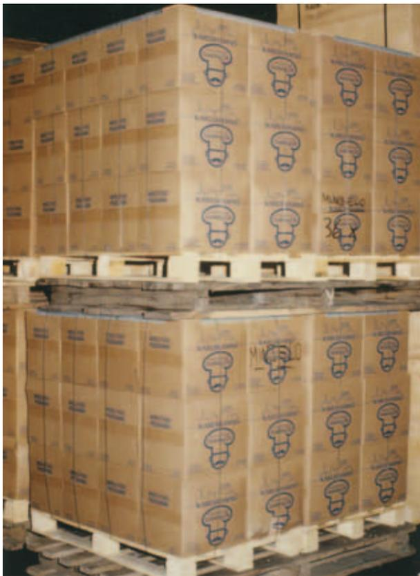
Bild 17: Sicherung bei Säulen durch vertikale Umreifungen.
