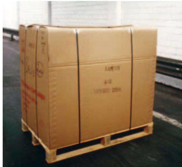
Bild 7: Sicherung einer einstückigen Ladeeinheit durch vertikale Stahlbänder
