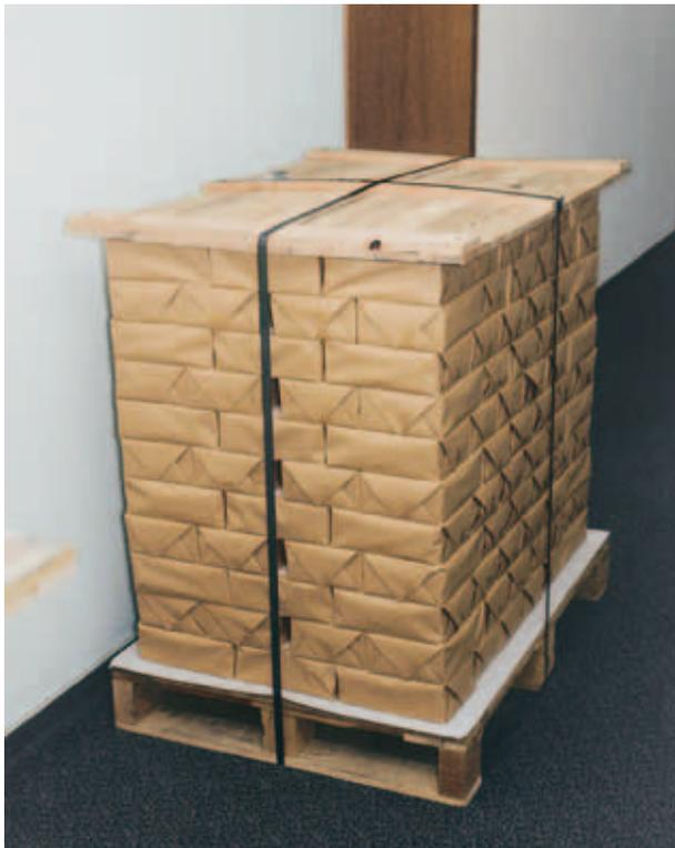
Bild 21: Abdeckplatten verteilen die Kräfte der Umschnürung bzw. Umreifung gleichmäßig über die obere Fläche der Ladeeinheit.
