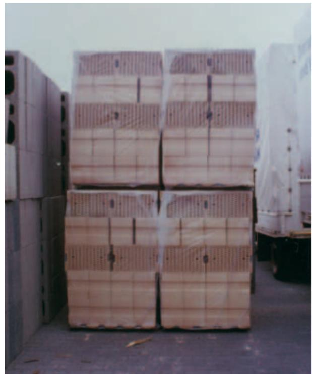
Bild 10: Sicherung eines Steinpaketes durch Schrumpffolie
