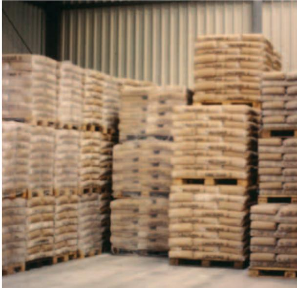
Bild 11: Im Verband auf Flachpaletten gestapelte Säcke: Die Ladeeinheiten sind zusätzlich durch Schrumpfhäuben gesichert.
