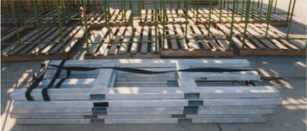
Bild 19: Spezialpaletten für Dämmplatten
