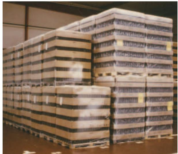
Bild 13: Bei aus Lagen bestehenden Ladeeinheiten sind in der Regel weitere Maßnahmen zur Ladungssicherung erforderlich, z. B. das Anbringen von Schrumpfhäuben.
