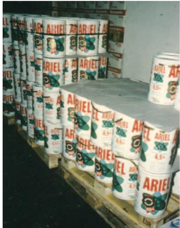
Bild 16: Sicherung bei Säulen durch Zwischenlagen und horizontale Umreifung der obersten Lage.
