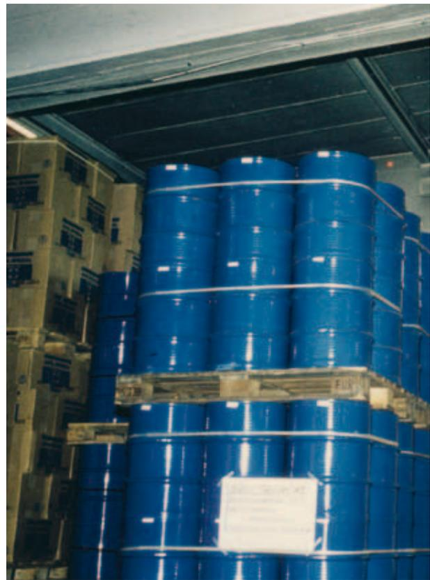
Bild 18: Fassstapelung: die formschlüssig zu Stapelsäulen aufgesetzten Fässer, werden durch horizontale Umreifungen zusammengehalten.
