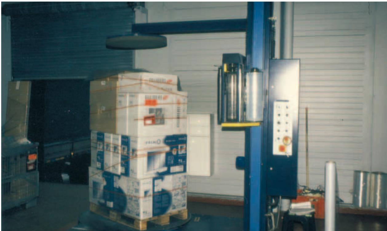
Bild 6: Auf der Stretchmaschine wird in eine Folie durch mechanisches Dehnen eine Spannung eingebracht und die Folie in diesem Zustand mehrfach um die Ladeinheit gewickelt.
