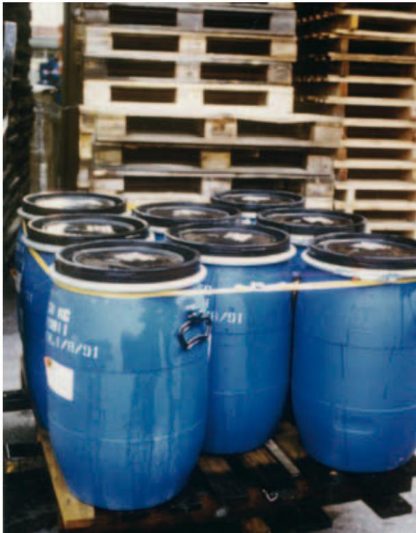
Bild 14: Sicherung von Fässern durch Textilgurt mit Spannschloss
