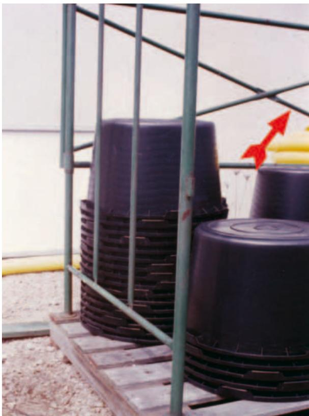
Bild 23: Durch Einsteckvorrichtung am hinteren Teil stabilisierter Aufsteckrahmen (s. Pfeil).
