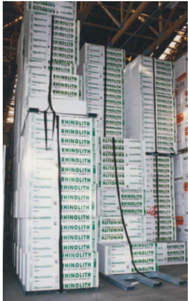
Bild 20: Dämmplatten auf Spezialpaletten werden durch vertikal angebrachte Gummibänder gesichert.
