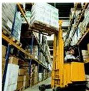
Wenn die Last angehoben wird, verlagert sich nicht nur der Lastschwerpunkt, sondern auch der Gesamtschwerpunkt nach oben. Als Folge der angehobenen Last kann der Gabelstapler leichter nach vorne und zur Seite kippen. Falls zusätzlich das Hubgerüst aus seiner größten Rücklage nach vorne geneigt wird, verlagert sich der Lastschwerpunkt und folglich auch der Gesamtschwerpunkt noch weiter nach vorne.
