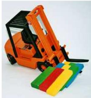
Gefährlicher als das Kippen nach vorne ist das Kippen des Gabelstaplers zur Seite. Gefährlicher deshalb, weil der Fahrer aus dem Fahrzeug fallen und dabei schwer oder tödlich verletzt werden kann. Deshalb ist es wichtig, die vorhandenen Rückhaltesysteme einzusetzen.
