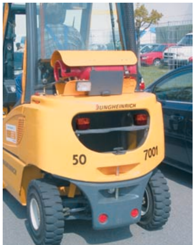
Bild 3: Schlussleuchten, Bremsleuchten, Rückstrahler und Fahrtrichtungsanzeiger
