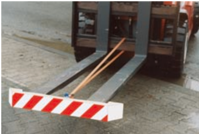
Bild 2: Schutzvorrichtung zum Abdecken der Gabelspitzen
