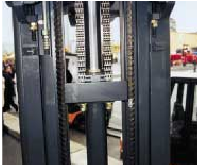
Abbildung 2: Blick vom Fahrersitz nach vorne bei einem Gabelstapler mit Triplexhubgerüst und mittig angeordnetem Hubzylinder
