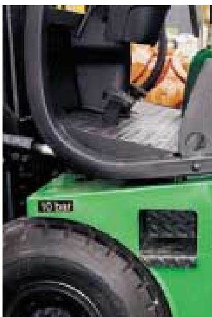
Abbildung 3: Auftritt, der beim Absteigen nur rückwärtsgehend benutzt werden kann
